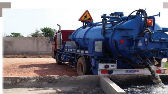
Camion déversant des boues d'épuration domestiques dans une station d'épuration, réduisant ainsi la pollution des eaux de surface et limitant les maladies d'origine hydrique
